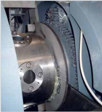
Raschiatore solidi con trasmissione ad ingranaggi.
